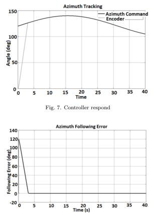
Fig. 8. Controller tracking error
